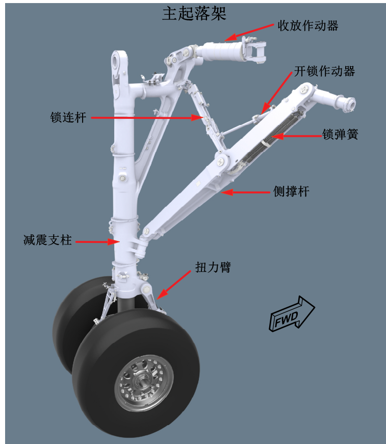
图 3 主起落架结构图(共1张 第1张)
